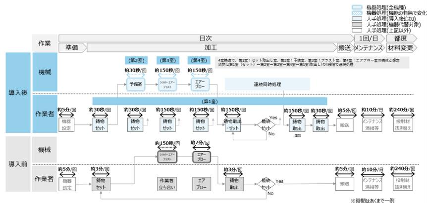
自動投入排出機能付き鑄造用ブラスト装置 (タンブラー型) 導入により装置への鑄物の投入・取り出し業務の工数を削減することが可能。
